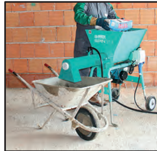
Mezcla morteros ensacados con gran rapidez (15/18 l/min.)
