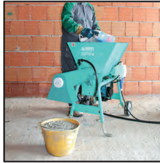
Mezcla morteros ensacados con gran rapidez (15/18 l/min.)
